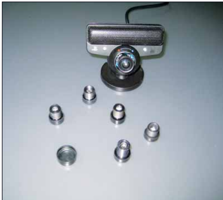
Photo 3 : La caméra PlayStation Eye et ses lentilles
