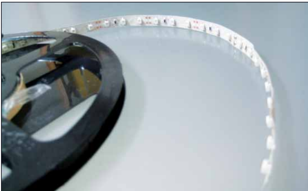
Photo 5 : Ruban de diodes prêt à poser
